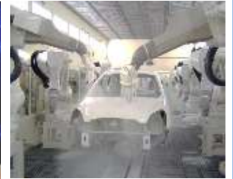
車体塗装システム
