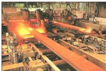
連続鑄造設備
