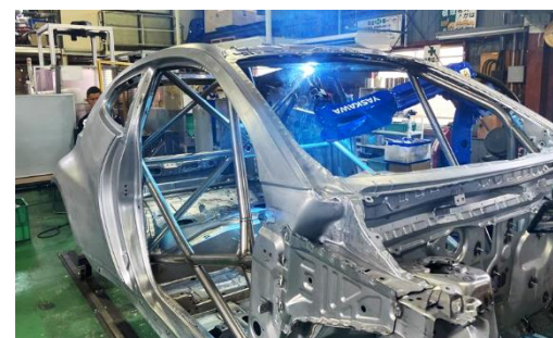
トヨタ自動車と開発した「SFA工法」の様子
