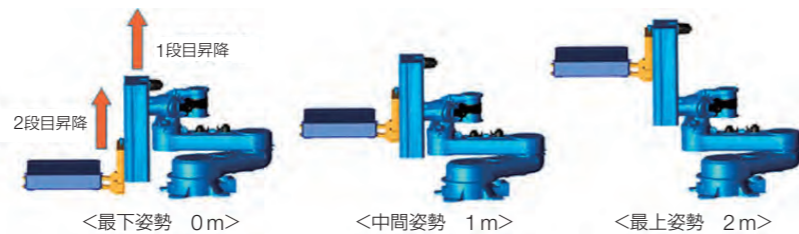
図2 上下方向ストローク機構(2段昇降式)
