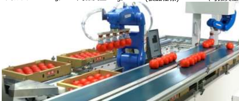
小型ロボットMotoMINIを使用したトマトのハンドリング
