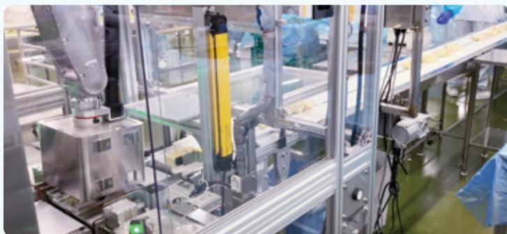
ふた閉めロボット稼働の様子
