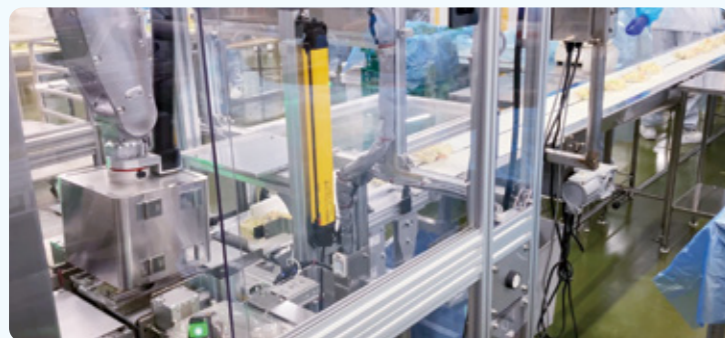
ふた閉めロボット稼働の様子
