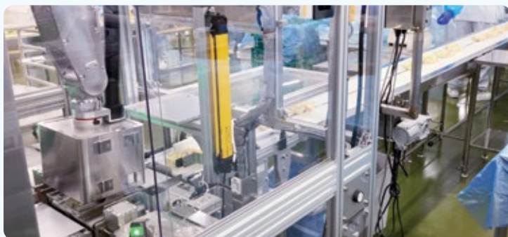
ふた閉めロボット稼働の様子
