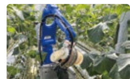
農業分野でのロボット活用 (きゅうりの葉かき作業を自動化)
