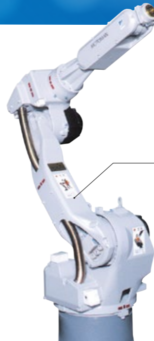
世界初 GaNパワー半導体搭載 アンパ内蔵サーボモータ(2017年)
