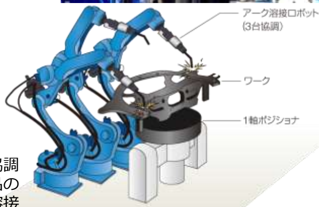
アーク溶接の加工点の様子
