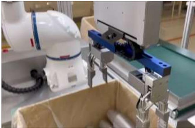
AIを活用し段ボール箱に段積みされたカップを取り出すロボット
