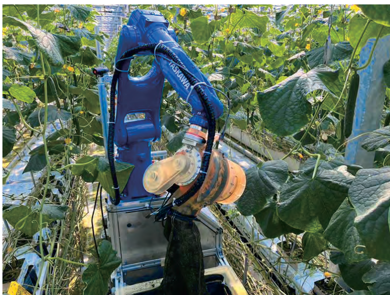
ゆめファーム全農SAGAで実証中の “きゅうり葉かきロボット”
